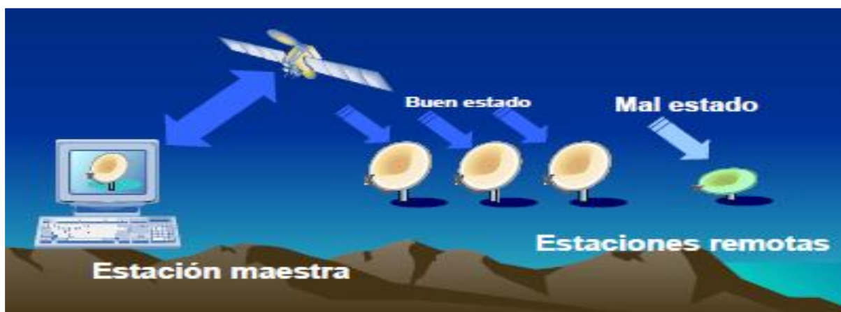
Fig 15 sistema de gestión de red www.pewwww.wfmmtelecom.com.pe
