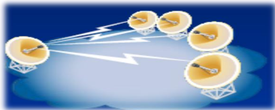
Fig 13 topología de estrella( conexión VSAT) www.pewwww.wfmtelecom.com.pe
