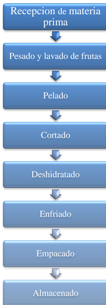
Ilustración 9: Proceso de elaboración de fruta deshidratada
