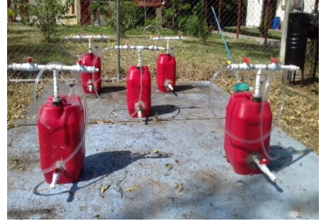
Figura 15: Unidad experimental de Biodigestores
