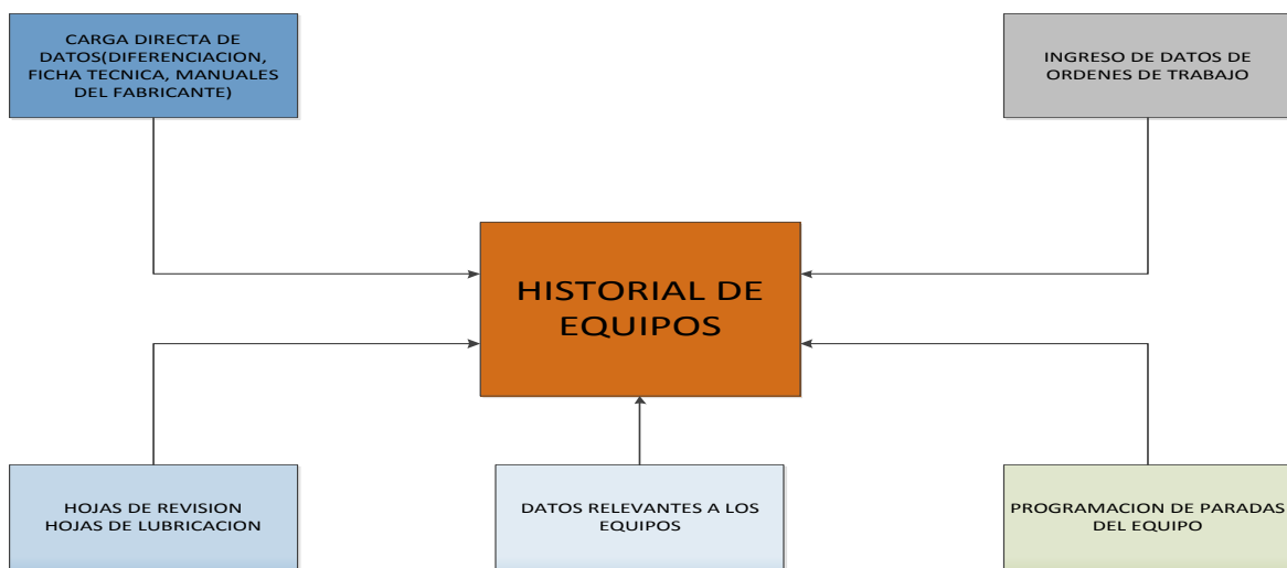
Figura 6.3: Distribución de la carga de información y actualización de una carpeta de equipo.
