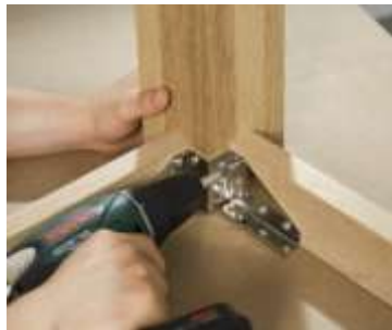
Foto: Técnico de Tienda Instala una unión (bisagra) en la parte inferior de una mesa
