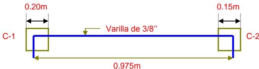
$$\text{Long: } 1.15\text{m} - (0.10\text{m} + 0.075\text{m}) = 0.975\text{m.}$$
