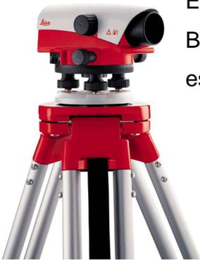
En dicho levantamiento topográfico que realizamos en la Boquita se empleo el nivel LEICA NA720, este nivel es fabricado especialmente para constructores, ingenieros y topógrafos.
