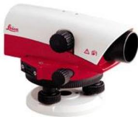
Tiene un factor de multiplicación de 100m, con una constante de adición igual a cero, y un nivel de burbuja de  $10\prime/2\text{mm}$ ; y una precisión (desviación óptica) por km (2 pasadas) de 2.5mm.
