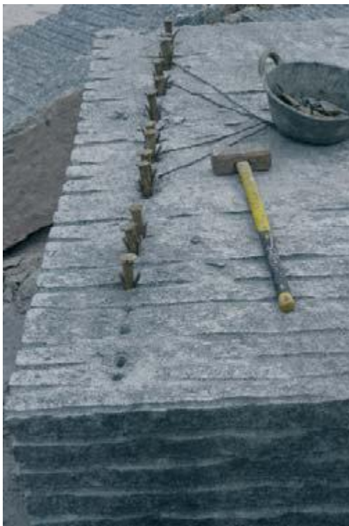
Corte de escuadrado mediante cuñas en las Banderas
