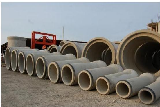
Alcantarillas de concreto
