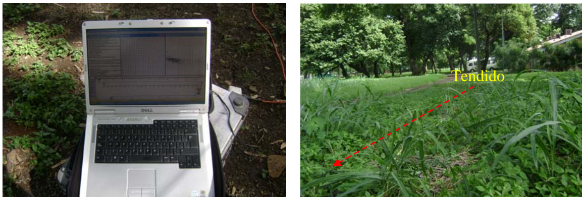
Fig. 20 a) Adquisición de registros MASW activo. b) Línea de geófonos de 46 m de longitud.
