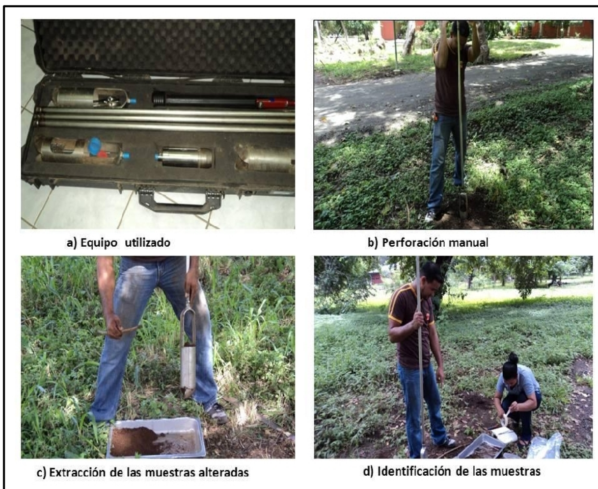
Figura 4.3 “Extracción de las muestras a través de sondeos manuales en el área de estudio”
