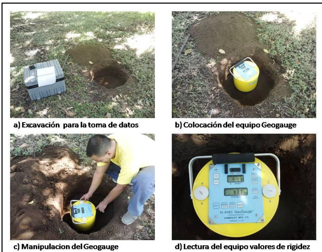
Figura 4.6 “Procedimiento para la determinación de los valores rigidez con el Geogauge”.
