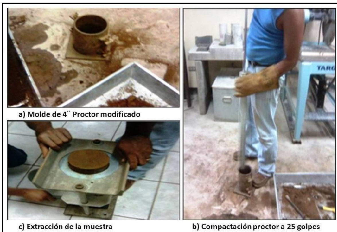
Figura 4.7 "Ensayo de proctor modificado en laboratorio".
