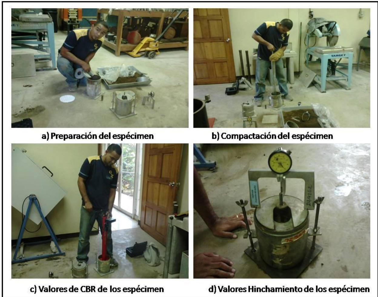
Figura 4.8 “preparación de los especímenes para CBR e Hinchamiento”
