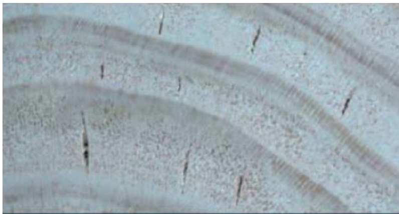
figura 5: Grietas internas dentro de los anillos
