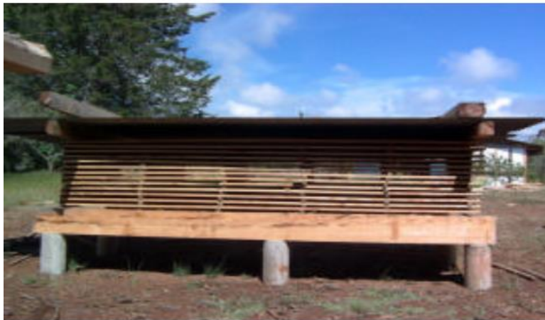
figura 1: Ordenamiento de madera en secado empírico
