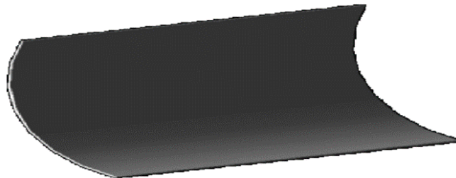
figura 13: Reflector de la corriente de aire
