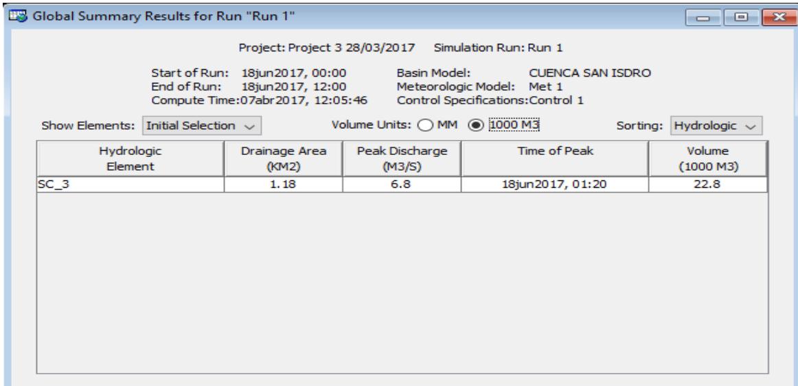
Figura 11. Resumen de resultados de la micro cuenca 3. (Caudal punta, precipitación total, lluvia neta en el suelo y lluvia neta).
