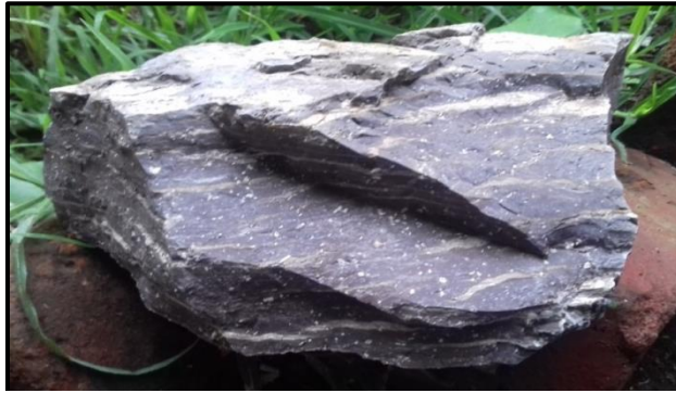
Foto 7: Riolita Silicificada con fracturas rellenadas por cuarzo (1412842N, 0552764E)
