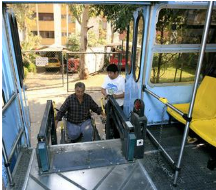
Rampa para minusválido en unidades de buses
