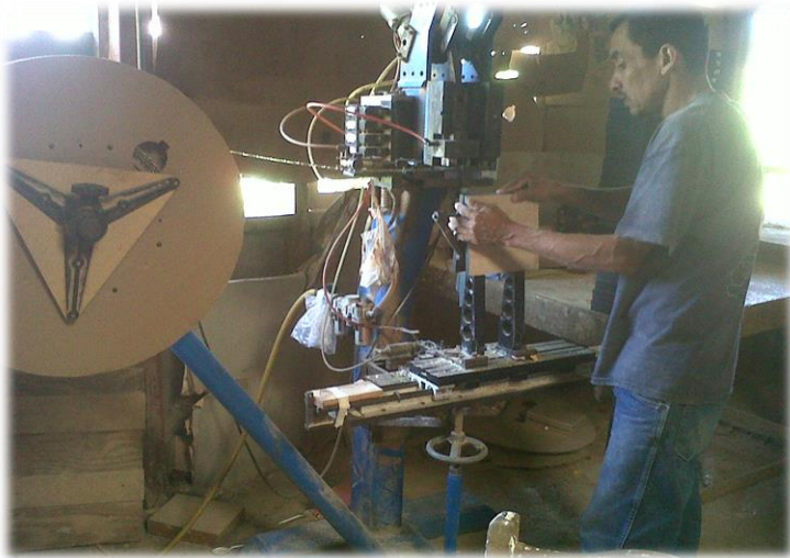
Ilustración 3: Obrero opera la Embisagadora
