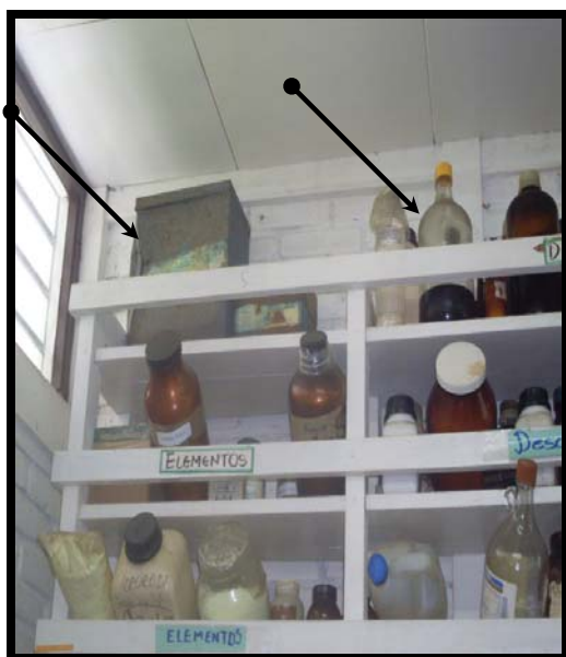
Fig. nº 22 y 23. Se observa que el almacenamiento de los reactivos químicos se ha realizado por orden alfabético sin tener en cuenta la reactividad entre ellos y los riesgos existentes. Además se indica que hay reactivos desconocidos y no utilizados que reducen el espacio de la bodega.
