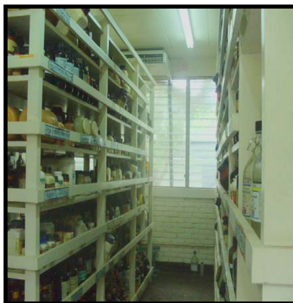
Fig. nº 22 y 23. Se observa que el almacenamiento de los reactivos químicos se ha realizado por orden alfabético sin tener en cuenta la reactividad entre ellos y los riesgos existentes. Además se indica que hay reactivos desconocidos y no utilizados que reducen el espacio de la bodega.
