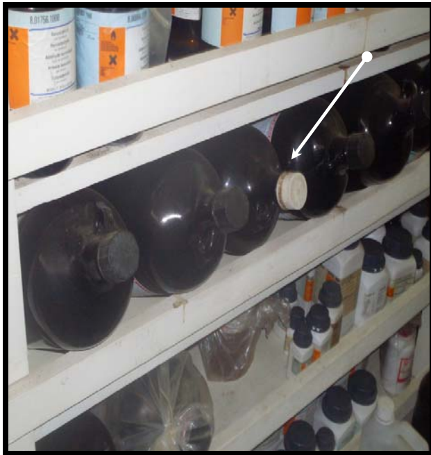
Fig. nº 24 y 25. Se indica que las divisiones de los anaqueles no alcanzan la altura requerida para el almacenamiento de reactivos con envases grandes
