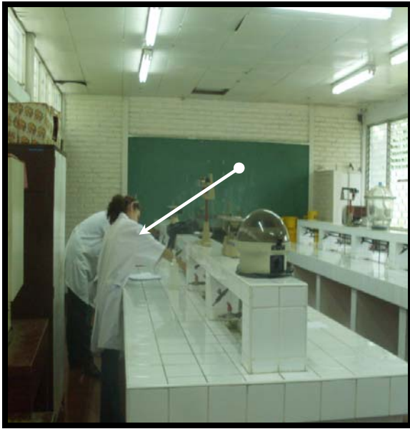
Fig. nº 36 Se indica que lo estudiantes descartan los residuos sólidos y líquidos en las canaletas de los mesones de trabajo, lo que deteriora a los mismos.
