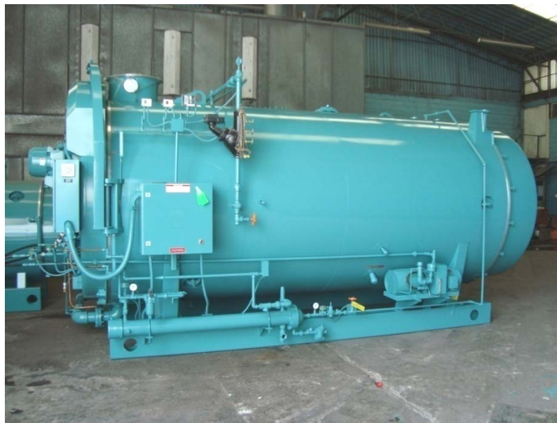
Ilustración 6 Maquina Actual (Caldera de Bunker)
