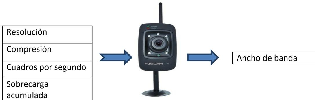
Fig. 14 Parámetros para el cálculo del ancho de banda
