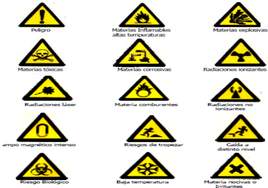
Figura 2: Señales de advertencia
