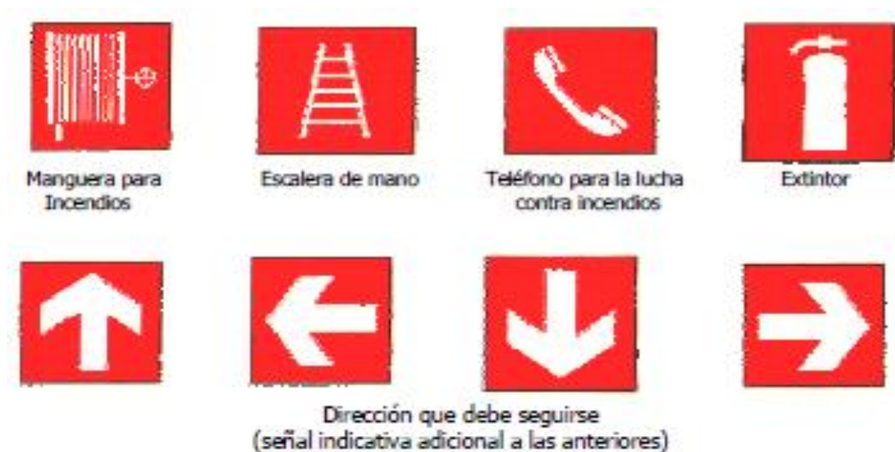
Figura 4: Señales relativas a los equipos de lucha contra incendios
