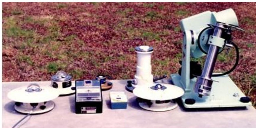
Figura2.13 Instrumentos para medir tipos de radiación solar, Global, Directa y Ultra violeta
