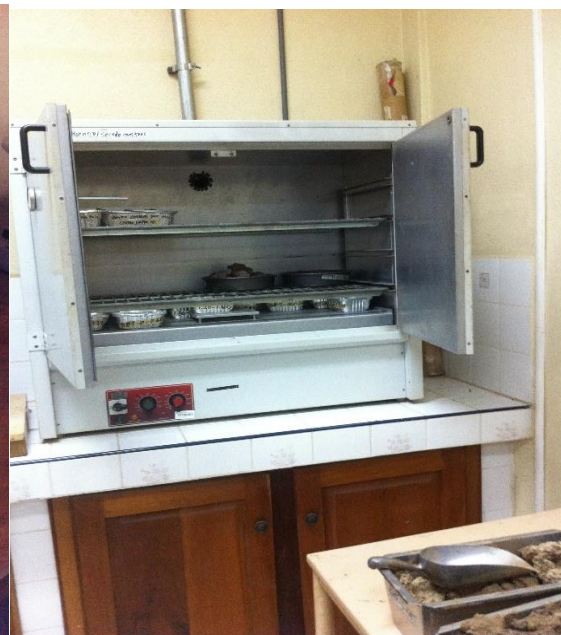
Ilustración2. Determinación de la humedad in-situ y alterada
