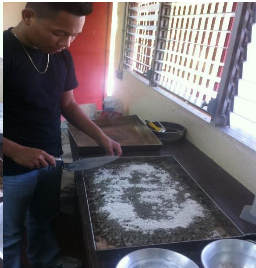
Ilustración 5. Cribado del material, homogenización con estabilizantes para ensaye proctor
