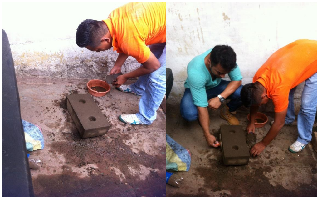
Ilustración 9. Extracción del bloque del molde y curado
