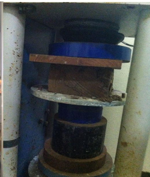
Ilustración 10. Máquina cortando el adobe y la máquina universal de compresión
