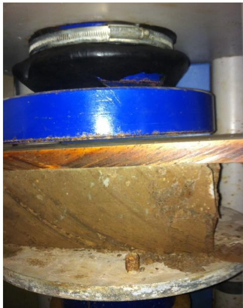
Ilustración 10. Máquina cortando el adobe y la máquina universal de compresión
