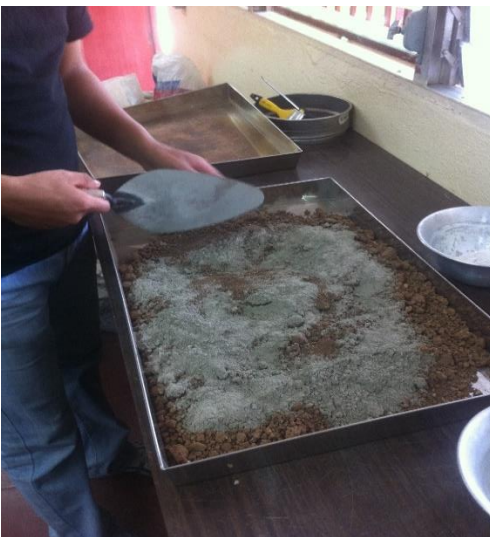
Ilustración 5. Cribado del material, homogenización con estabilizantes para ensaye proctor
