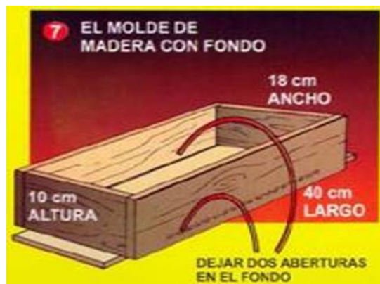
Figura 21. Molde para fabricación de adobes con fondo
