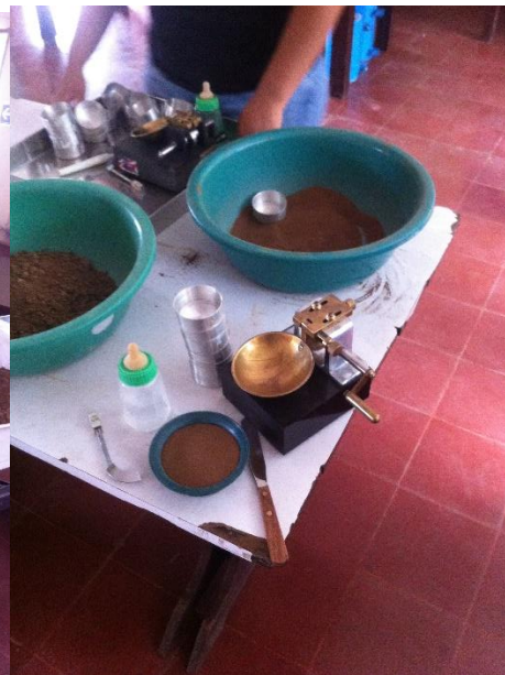
Ilustración 3. Proceso para determinación de Límites: Líquido y plástico
