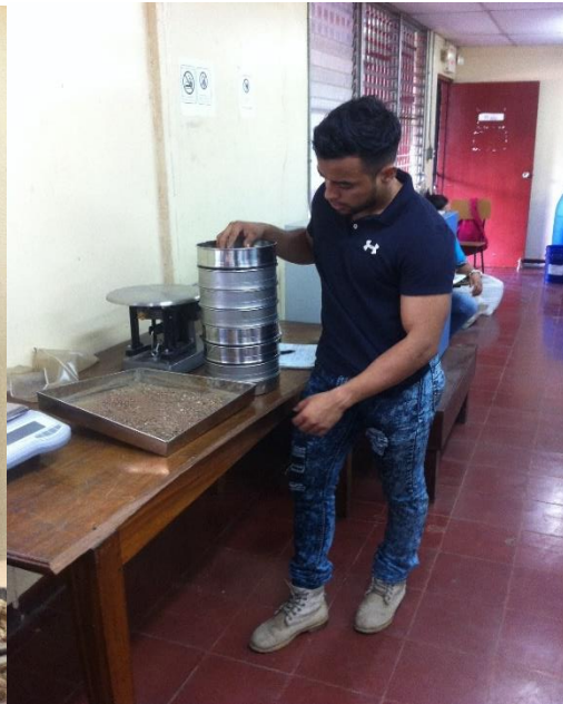
Ilustración 1. Lavado del material por el tamiz #200
