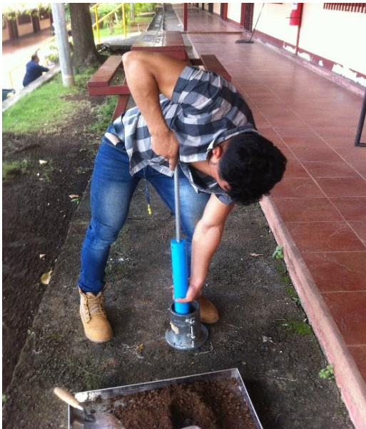
Ilustración 6. Homogenizado y compactación del material en el ensaye proctor
