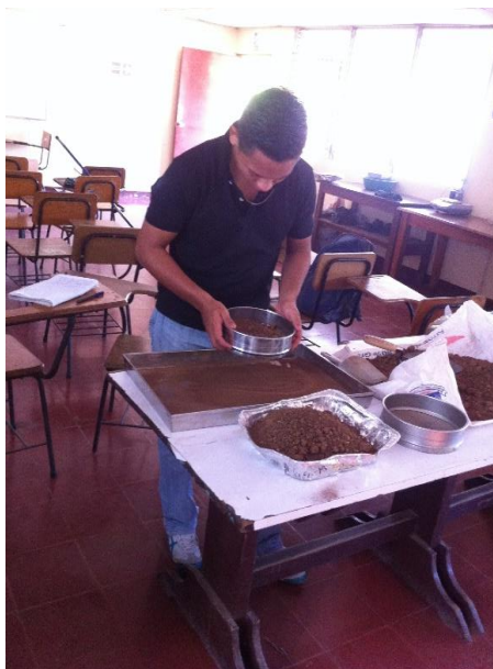
Ilustración 3. Proceso para determinación de Límites: Líquido y plástico
