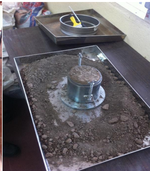
Ilustración 6. Homogenizado y compactación del material en el ensaye proctor
