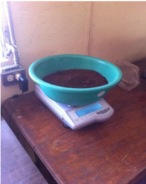
Ilustración2. Determinación de la humedad in-situ y alterada
