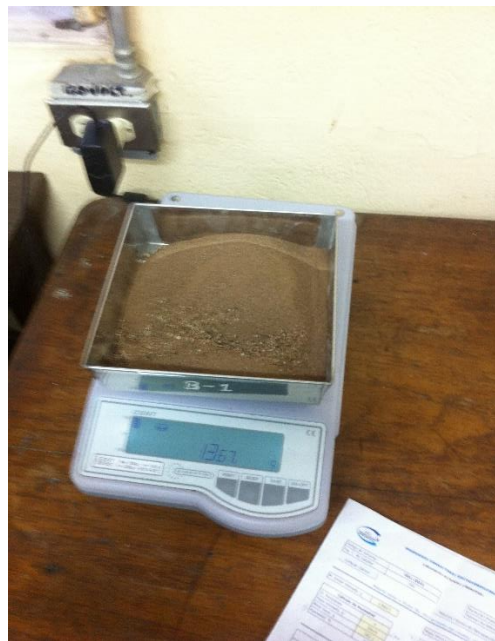
Ilustración 2. Granulometría del suelo después de ser lavado y secado en el horno
