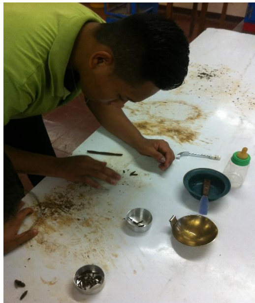
Ilustración 4. determinación de límite líquido y limite plástico
