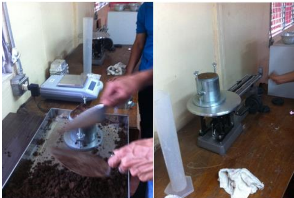
Ilustración 7. Determinación del peso del material y humedad; compactado en sus tres capas
