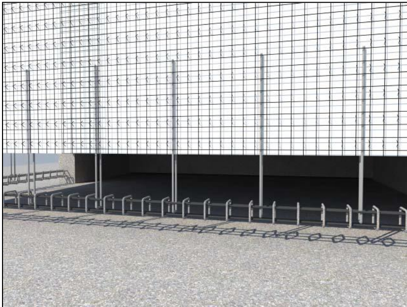
Figura 9: Fundaciones en anclaje U
