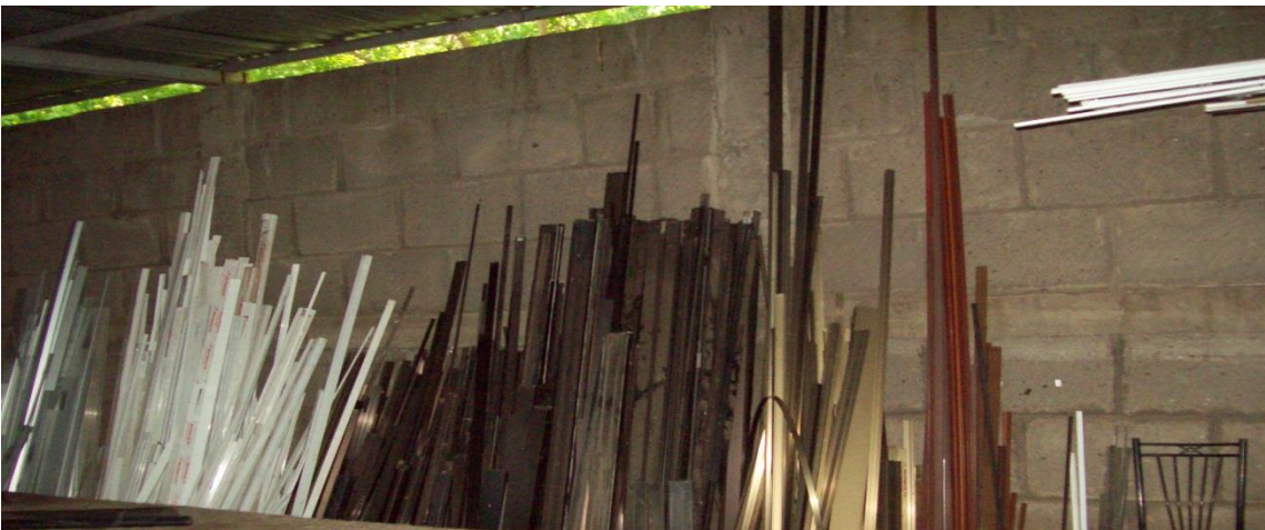
Figura 38. Angulares de aluminio almacenados inadecuadamente.
