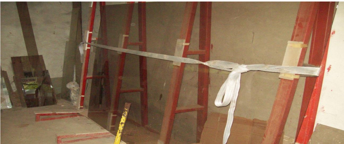
Figura 41. Almacenamiento de vidrio con desperdicios de trabajos anteriores.
