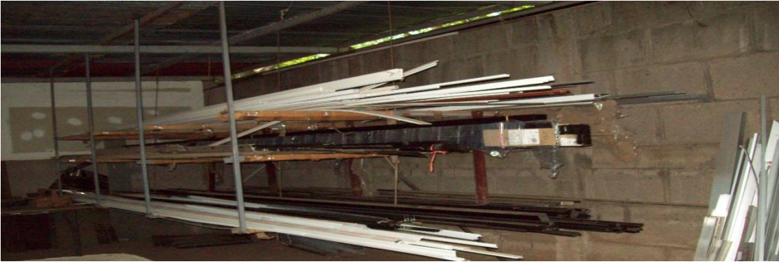
Figura 39. Angulares de aluminio expuestos almacenados sin indicaciones de seguridad.
