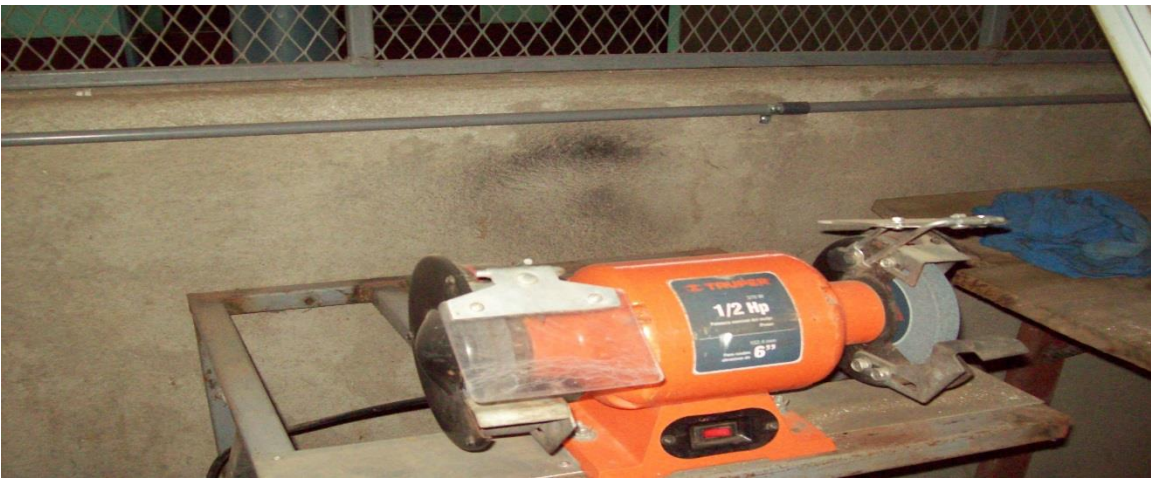
Figura 35. Esmeril sin protección en un extremo y sucio.
