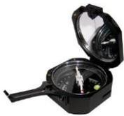
fig. 4 imagen de brujula brumton fuente: (imágenes google) La Brújula Brumton es un equipo de precisión que usa en el campo magnético terrestre para medir orientaciones en campo. Es usado generalmente por Ingenieros Geólogos e Ingenieros Civiles y Topógrafos.
