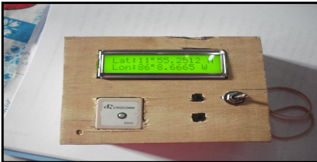
Fig 7 Modelo de sistema GPS su tamaño no excede la palma de la mano, propia fuente
