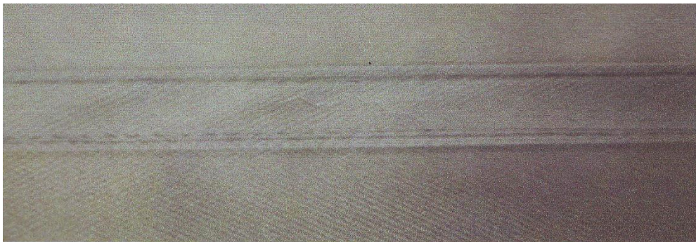
Figura 8. Desalineado de handle: este defecto es producido por manualidad del operario, se visualiza al poner el pliegue panel a la luz.
