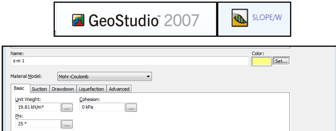
Figura 4.9. Inserción de datos de entrada para determinar el factor de seguridad dinámico
