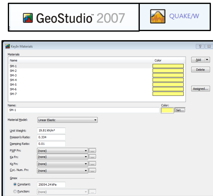
Figura 4.6. Inserción de datos de entrada para determinar los esfuerzos estáticos iniciales
