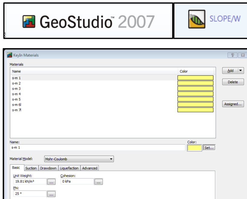
Figura 4.5. Inserción de datos de entrada para determinar el factor de seguridad estático
