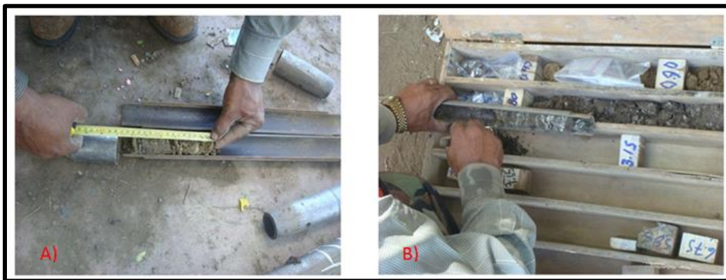
Figura 4.2. A) Muestra recolectada por SPT y B) Muestra recolectada en bolsas herméticas de polietileno y puestas en una caja de madera
