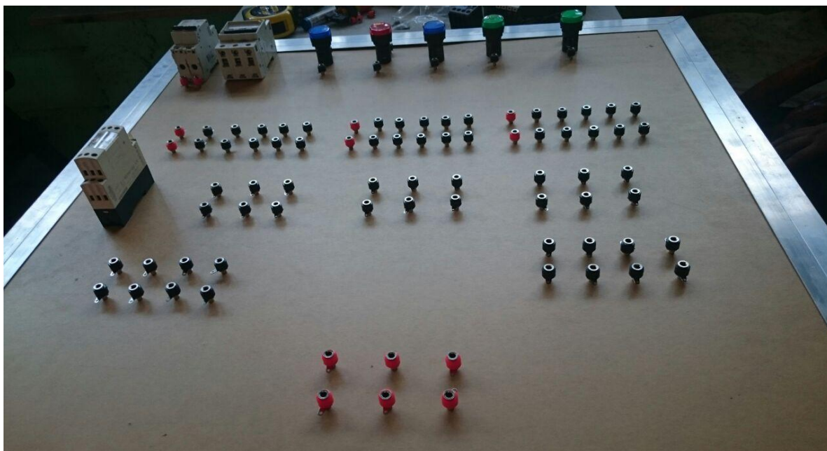
Ilustración 63 Colocación de los sockets y algunos dispositivos eléctricos
