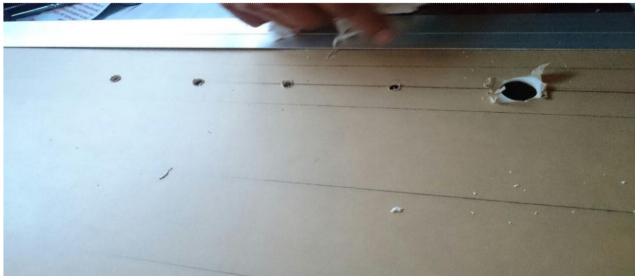
Ilustración 20 Proceso de perforación de agujeros en el acrílico
