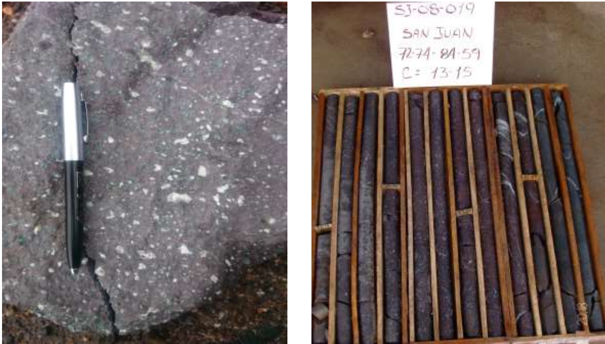
Foto 10. Andesitas porfíricas, porfiroclastos de plagioclasas. SJ-08-019.
