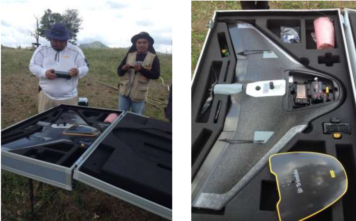
Foto 1. Drone Trimble UX5, utilizado en el levantamiento topográfico detallado.
