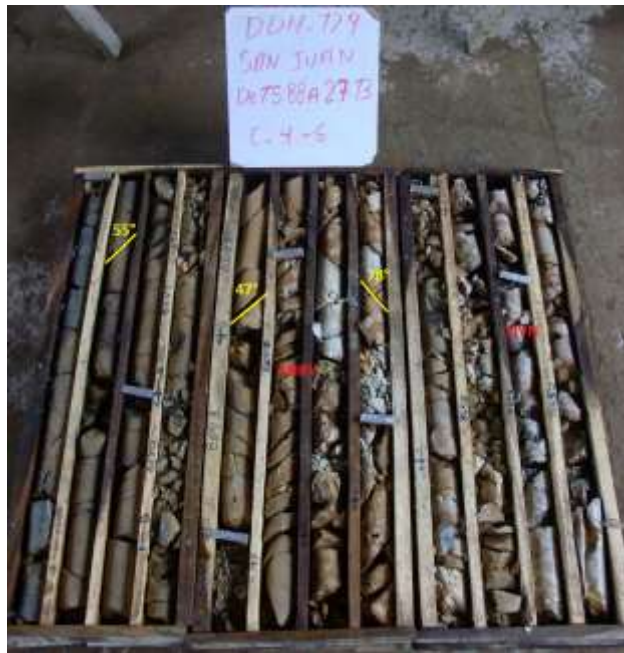
Foto 13. Zona de falla en sondeo SJ-08-06.
