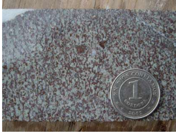
Foto 7. Flujo de composición basáltica interceptado en el sondeo SJ-08-022 a una profundidad de 59.48 m.
