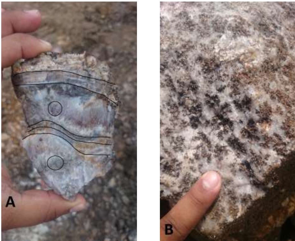
Foto 14. A) Veta de Cuarzo con textura en bandas coloforme - crustiforme y vuggy. B) Veta de Cuarzo con textura masivo sacaroidal.
