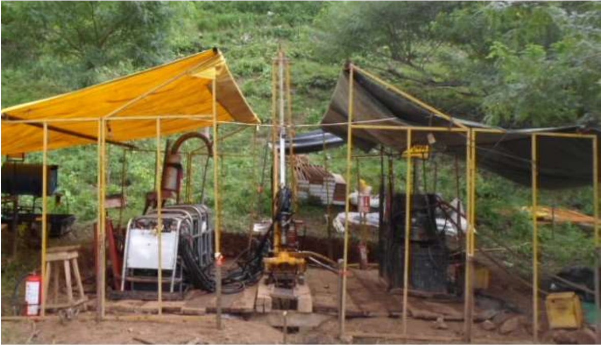
Foto 4. Máquina perforadora diamantina rotativa modelo Gopher UG 3000.
