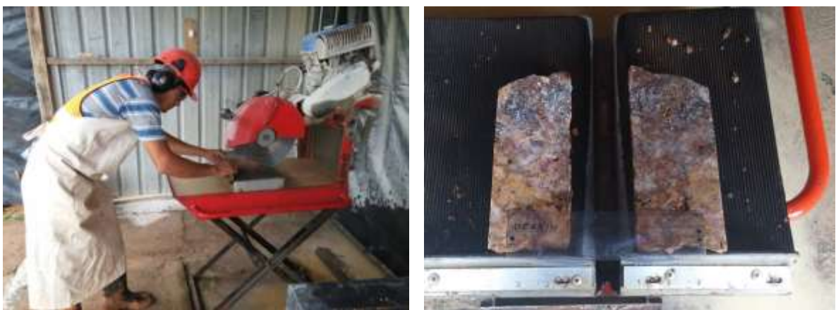
Foto 6. Procedimiento de corte de muestras en núcleos de perforación.
