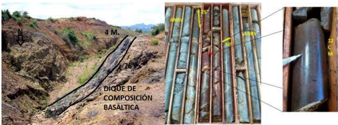
Foto 12. Dique de composición basáltica aflorando en superficie e interceptado en sondaje, SJ-08-008.
