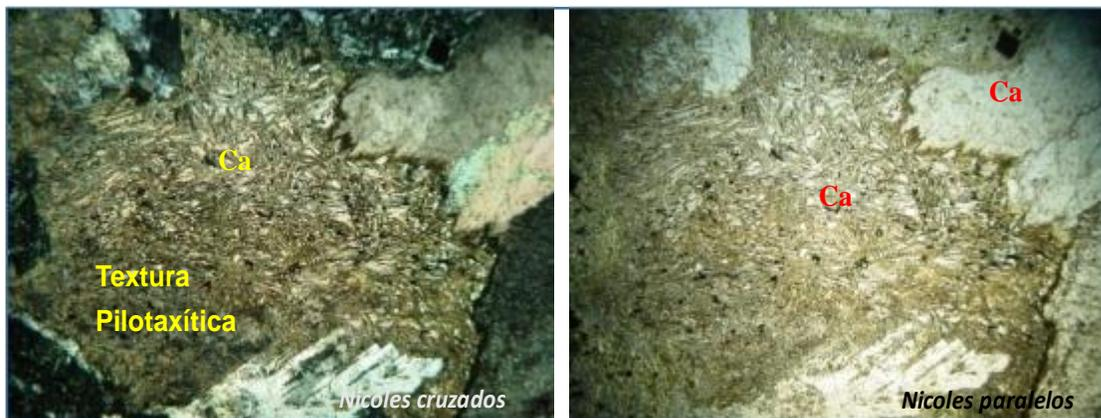
Foto 4- 7. Matriz con textura Pilotaxítica con reemplazamiento a carbonato de calcio (Ca) y con fenocristales de carbonato de calcio presentes en la matriz.
