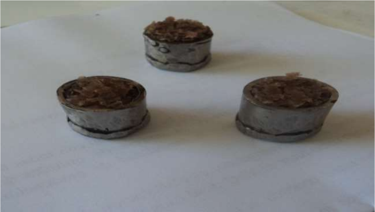
Foto 11: Probetas con el biopolímero para determinar humedad.
