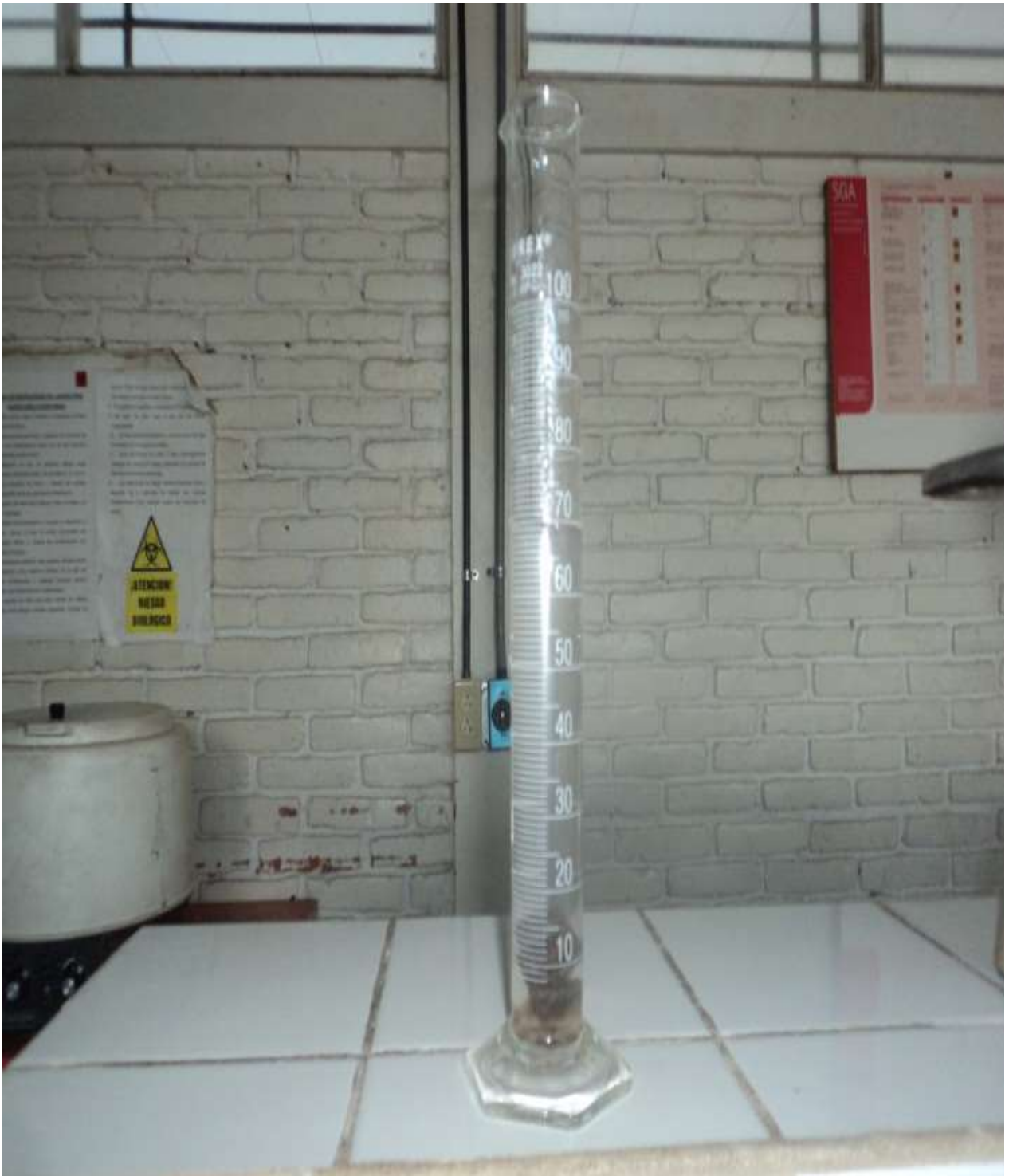
Foto 15: Prueba de densidad del biopolímero
