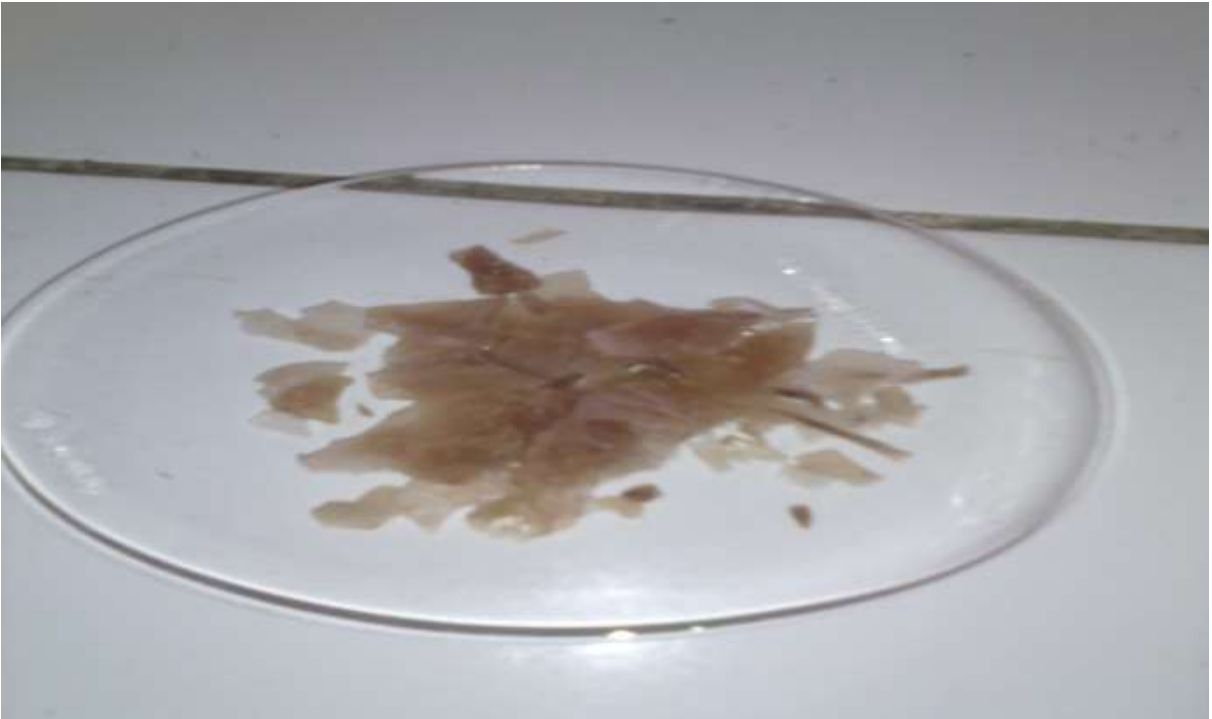
Foto 13: Muestra del biopolímero plástico para análisis de temperatura de fusión.
