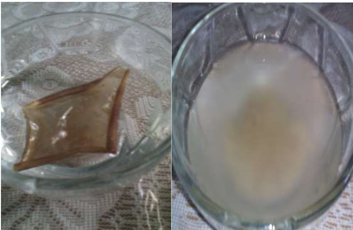
Foto 10: Pruebas de adsorción de agua del biopolímero plástico.
