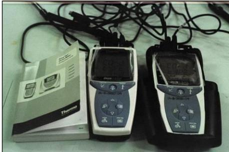
**Figura 7.1** Equipo de medición de parámetros de calidad de agua utilizados en campo (noviembre del 2011 – julio de 2012).
