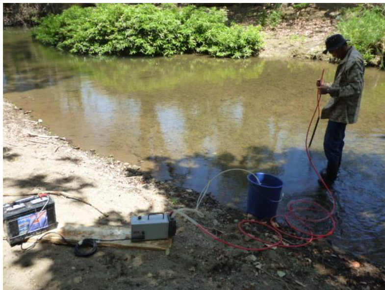
Foto 1. Medición de la relación aguas superficiales y aguas subterráneas, mediante el uso de un minipiezómetro.
