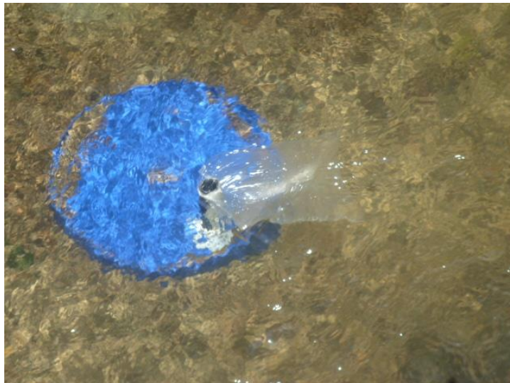
Foto 2. Prueba Seepage para determinar la dinámica del acuífero con los ríos.
