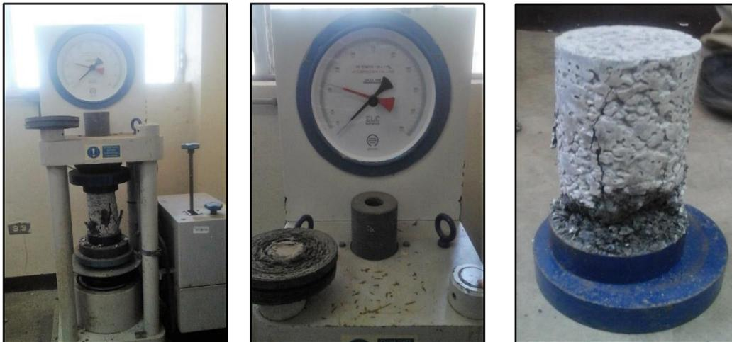
**Figura 5.4. Concreto a compresión hidráulica, lectura de resistencia y ruptura del espécimen.**
