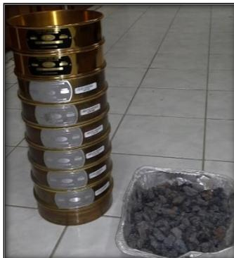
**Figura 4.9. Granulometría del agregado grueso.**
