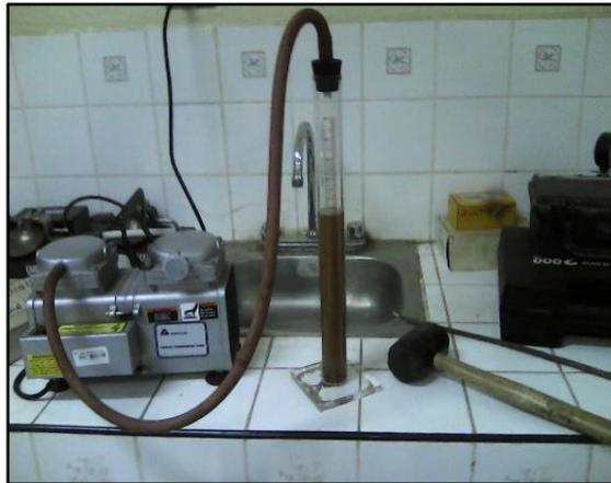
Figura 4.6. Ensayo de gravedad específica expulsión de aire
