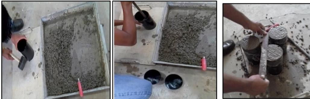
**Figura 4.13. Elaboración de concreto: Golpes con mazo de hule, Envarillado y enrasado de la mezcla.**
