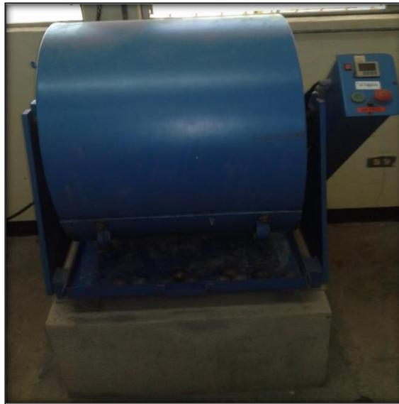
**Figura 4.10. Máquina de los ángeles, resistencia al desgaste por cargas abrasivas.**
