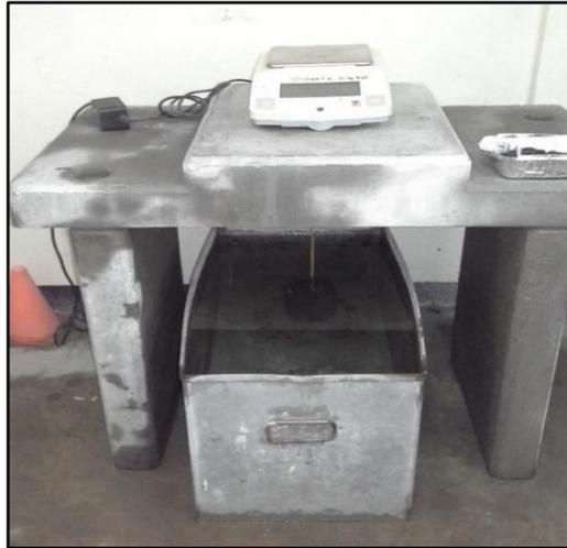
**Figura 4.7. Gravedad específica de la grava, peso de la muestra sumergida**
