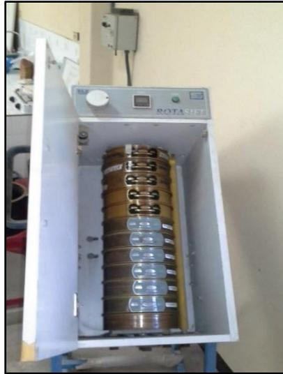
**Figura 4.8. Análisis granulométrico, muestra en el tamizador mecánico.**
