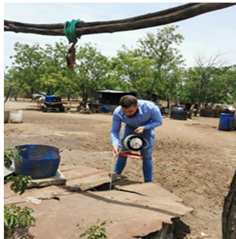
J)- Medición en pozo excavado, comunidad del Escobillal.
