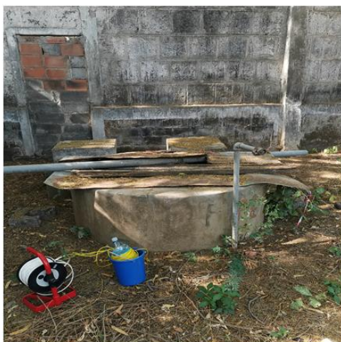
K)- Medición en pozo excavado, Bosques de Xiloá.
