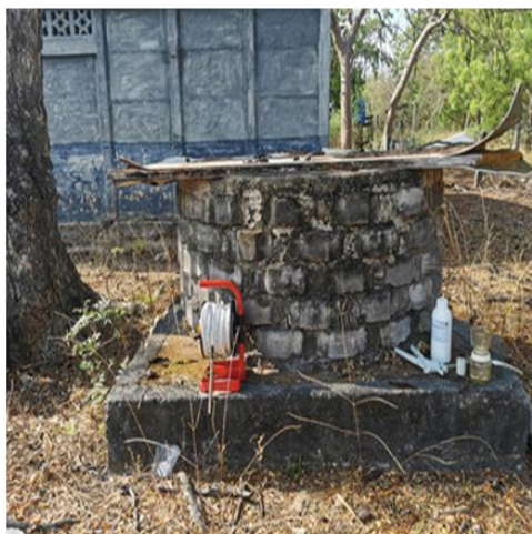
I)- Medición en pozo excavado, al sur de Bosques de Xiloá.
