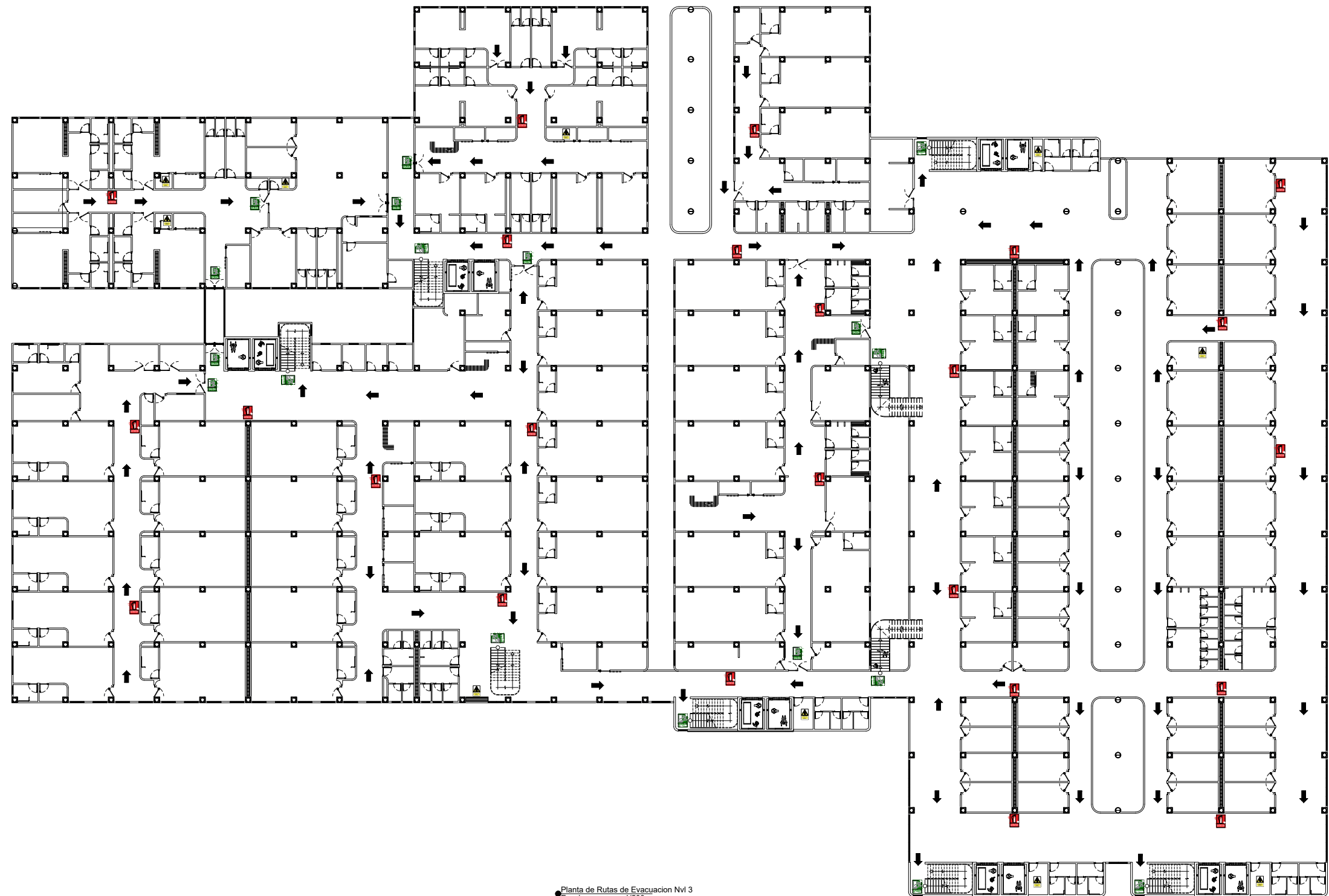
● Planta de Rutas de Evacuación Nvl 3 Escala:.....1/500
