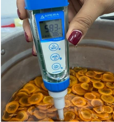
Figura 5. Medición de la acidez en el jarabe de sacarosa.
