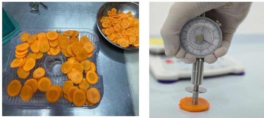
Figura 2. Medición manual de textura de la zanahoria
