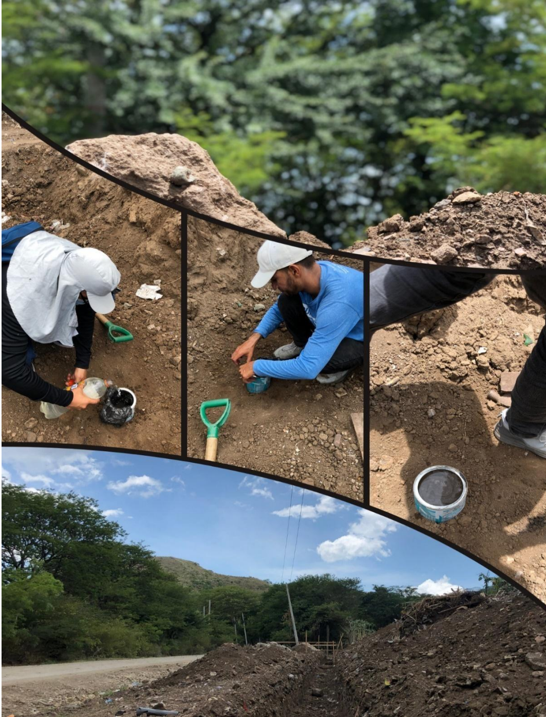
Aplicación de prueba de infiltración
