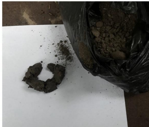
Aplicación de prueba al tacto del suelo
