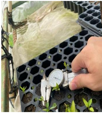
Imagen 10. Iniciamos con las mediciones semanales de altura, número de hojas y diámetro del tallo, registrando todos estos datos en hojas de campo.
