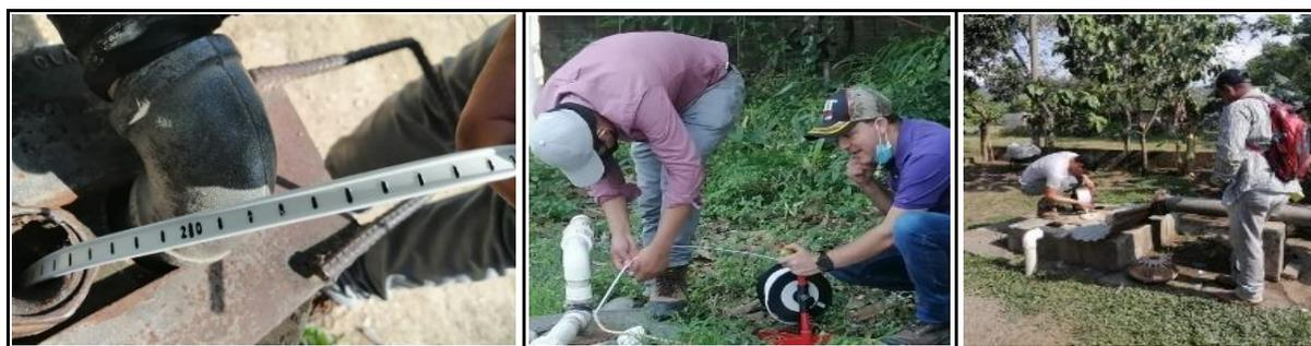
**Figura 11.** Medición de niveles estáticos de agua subterránea.
