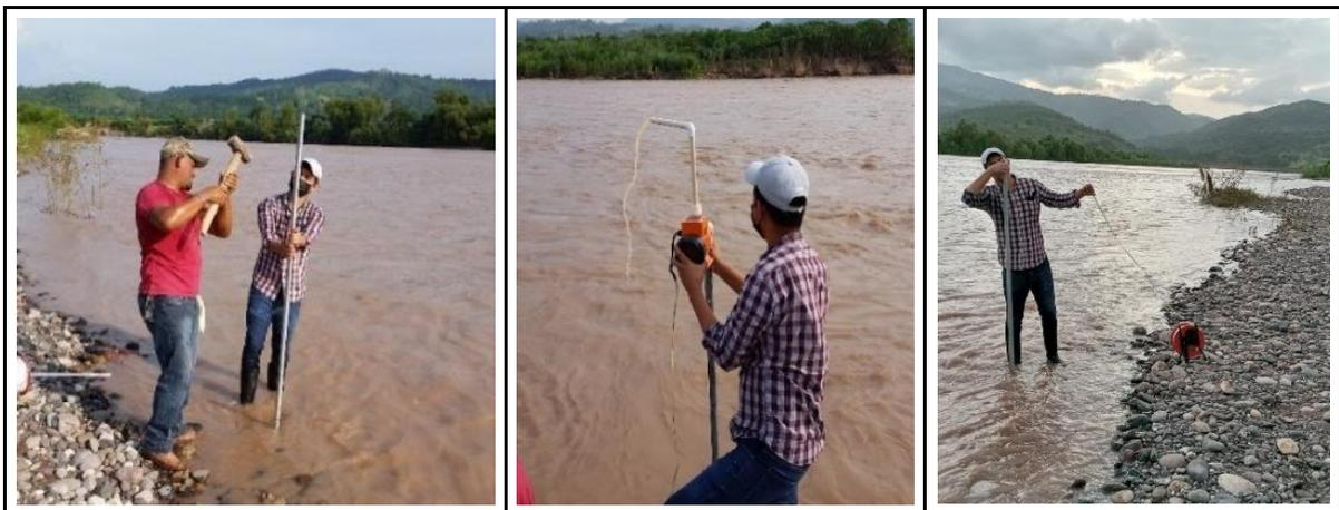
Figura 15. Instalación de mini-piezómetros.
