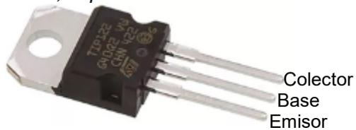
2. Manipulando el estaño se une la fotorresistencia LDR entre el emisor y base del transistor.
