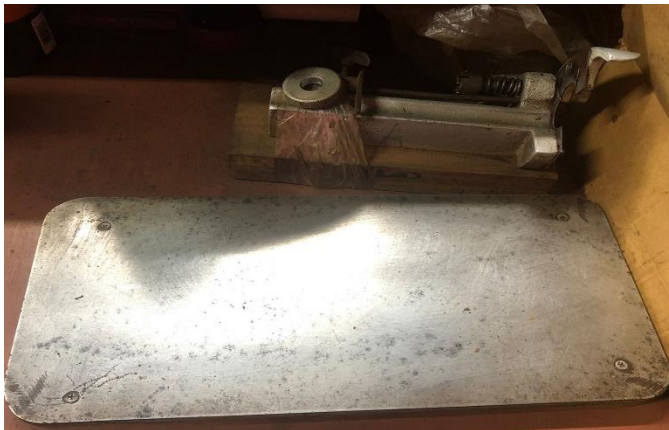
Anexo N° 12 - Tabla metalica utilizada por el bonchero, rodos de madera para estirar el tabaco y cortadora de puros.
