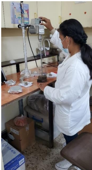
Foto 12. Agitador magnético de sedimentos
