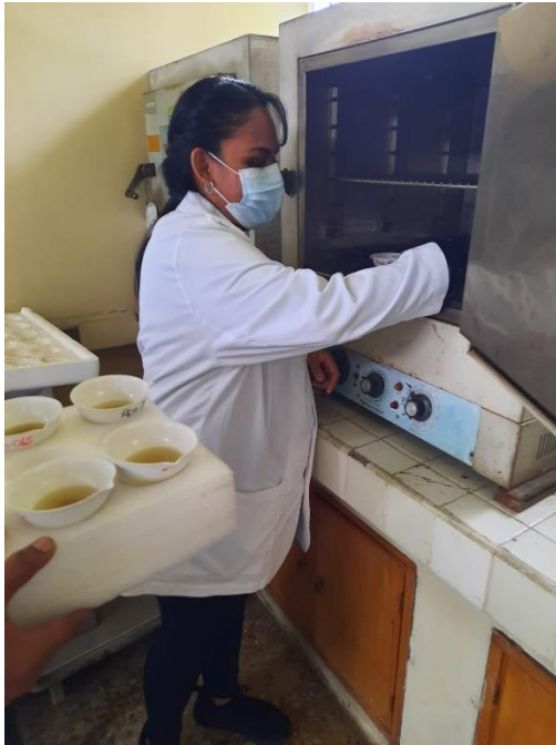
Foto 20. Colocación de muestras de sedimentos en el horno desecador
