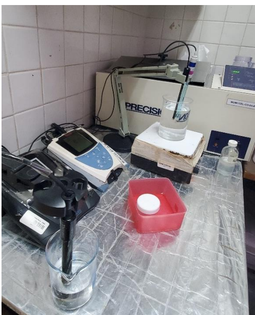
Foto 16. Medición de pH, conductividad y alcalinidad en muestras de agua
