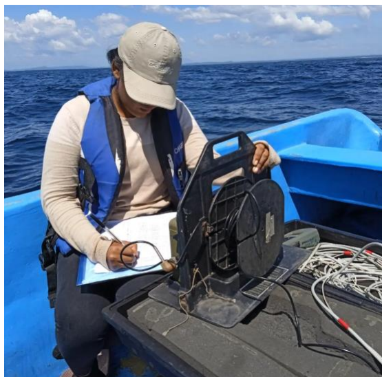
Foto 6. Medición de OD in situ
