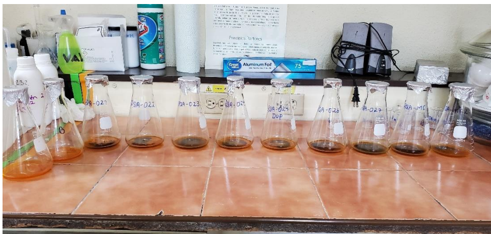
Foto 19. Determinación de materia orgánica en sedimentos
