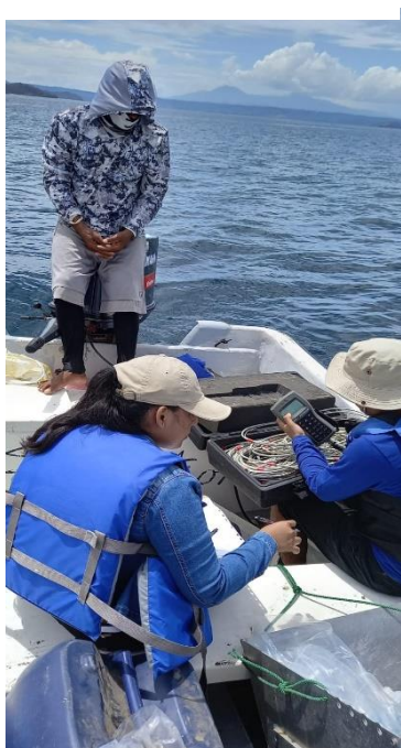
Foto 8. Medición de parámetros pH, Conductividad y Salinidad in situ
