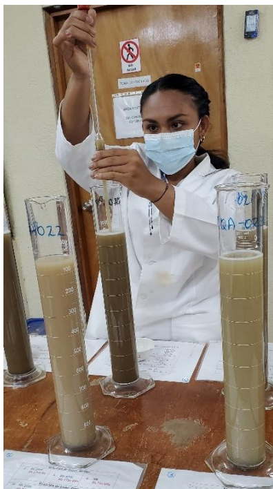
Foto 14. Pipeta Konh para determinación de limo y arcilla
