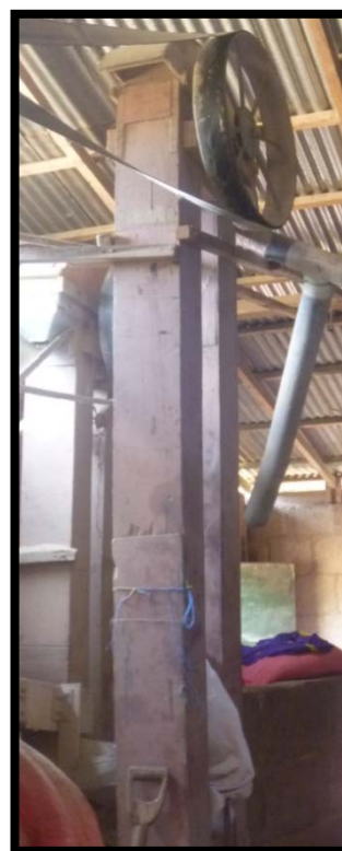
Segundo elevador que suministra la granza a la Descascarilladora
