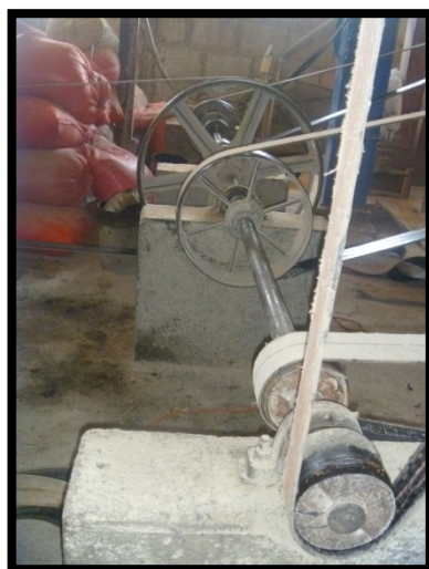
Eje principal que recibe el movimiento del motor para hacerlo llegar a todo el trillo
