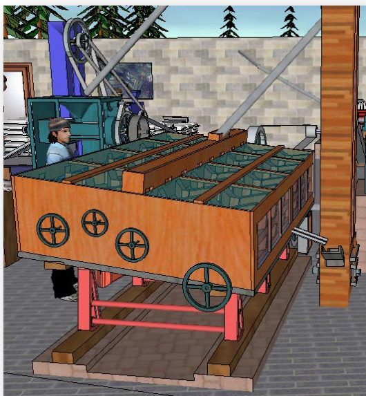
Mesa paddy, a su derecha se encuentra en elevador más alto y a su izquierda el operario que lleva la granza a la descascarilladora. (ACTUAL)
