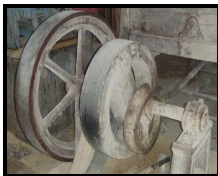
Poleas y excéntrica (la polea más grande equilibra la fuerza del motor para el accionamiento del trillo, el círculo más pequeño es la excéntrica que se conecta a la mesa paddy para su movimiento)
