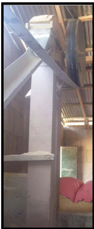
Primer elevador que lleva la Broza a la pre limpiadora
