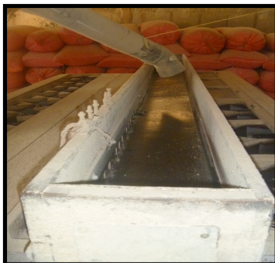
Parte superior de la mesa paddy, por donde circula el arroz aún con granza.
