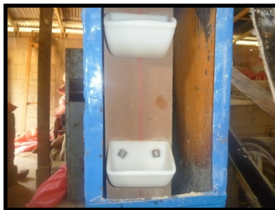
Guacales que portan internamente los elevadores.
