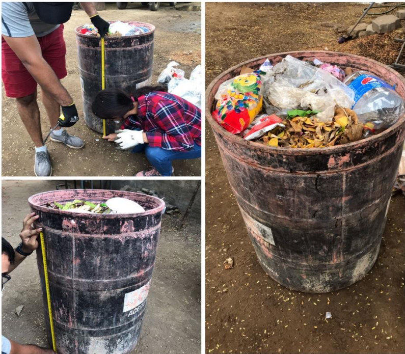
Ilustración 23. Determinación de la densidad.
