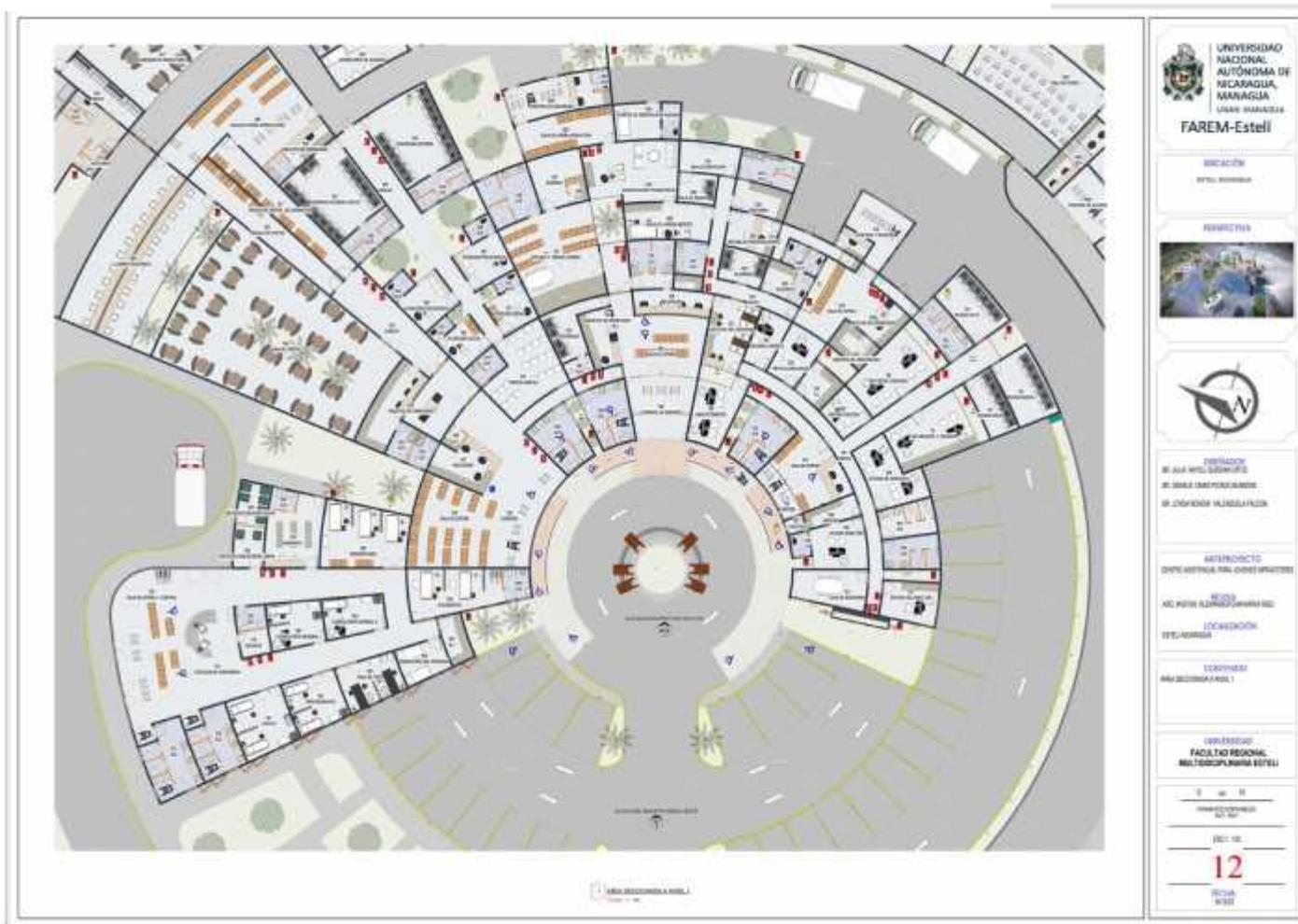
La **Figura 43** contiene la planta seccionada con las áreas de recreación, capilla, dormitorios y seguridad de acceso.
