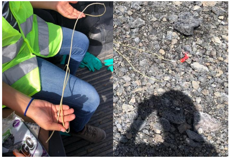
Cables de explosivos y detonador.
