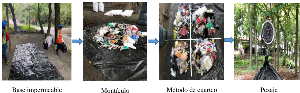
Figura 2. Procedimiento del método de cuarteo.
