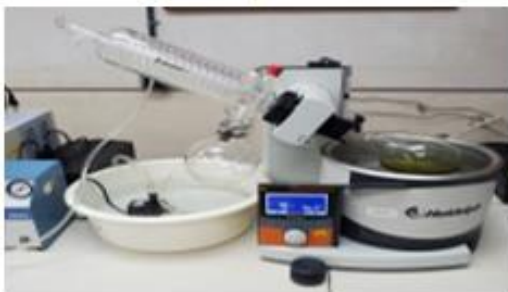
Separación del solvente y el extracto esencial mediante el rotaevaporador
