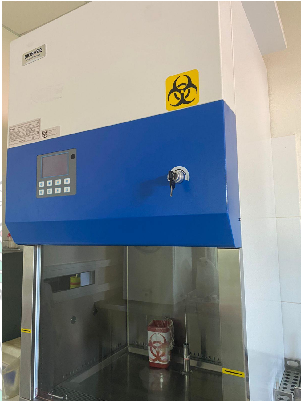
Cabina de bioseguridad del laboratorio clínico. Fuente: Imagen de elaboración propia
