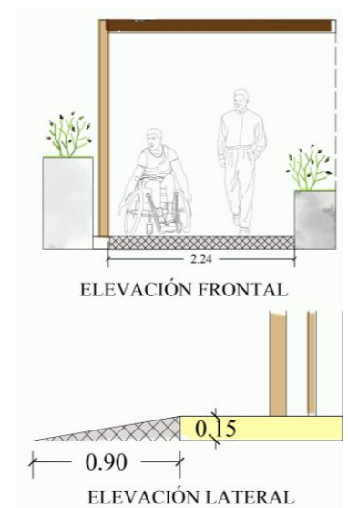
ILUSTRACIÓN 15 DETALLE DE RAMPA
